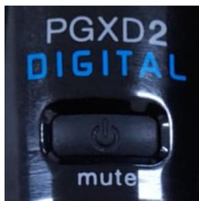
Desligue o microfone: pressione o botão e mantenha-o por cerca de 1 segundo até que o LED do microfone apague.
