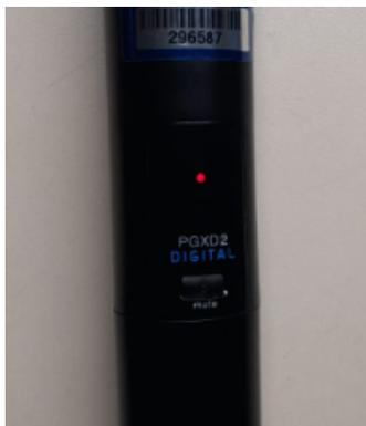
Se a luz estiver vermelha é um indicativo de que as pilhas (AA) estão com carga baixa. Para substituí-las, basta rosquear a parte inferior do microfone no sentido anti-horário, levantar a trava e efetuar a troca.
